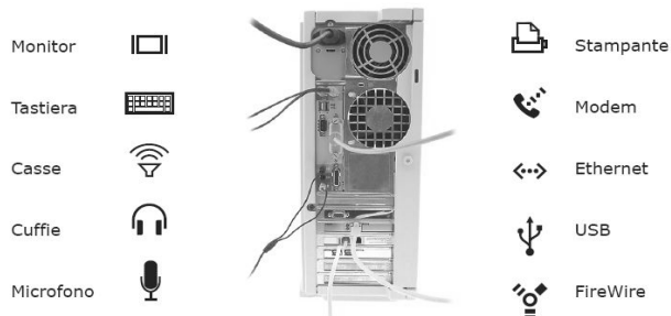
Figura 1.3 Icone normalmente utilizzate per mettere in corrispondenza i connettori dei cavi e le prese del computer.
